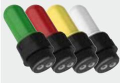
Les indicateurs lumineux servent à la visualisation du changement d'état du contact électrique à l'intérieur de l'interrupteur. Ils peuvent être installés sur les interrupteurs en les vissant à une des entrées pas utilisée pour le passage des câbles électriques. Degré de protection IP67.
