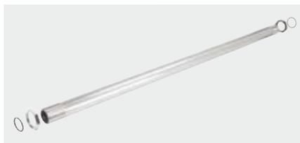
Kit tube Ø 25 mm en métal avec extrémités filetées M25x1,5 (pour VF KIT32, VF KIT33, VF KIT34, VF KIT35) avec écrou en métal et garnitures. Degré de protection IP65.
