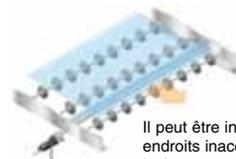
Il peut être installé dans des endroits inaccessibles aux barres ionisantes conventionnelles. Placé plus près de l'objet, il offre une neutralisation plus précise.
