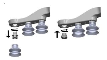
Le filetage couramment utilisé est le G1/8", ce qui permet de monter des fixations, des obturateurs et des extensions standard directement sur les préhenseurs VG.
