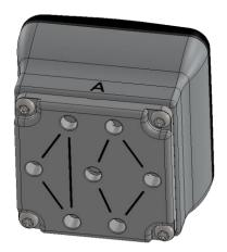
Pour monter la plaque d'adaptateur, simplement déposer les 4 fixations ou obturateurs à vis du préhenseur, placer la plaque d'adaptateur en choisissant l'angle droit en fonction de la configuration souhaitée, puis serrer les 4 vis à 4 Nm.
