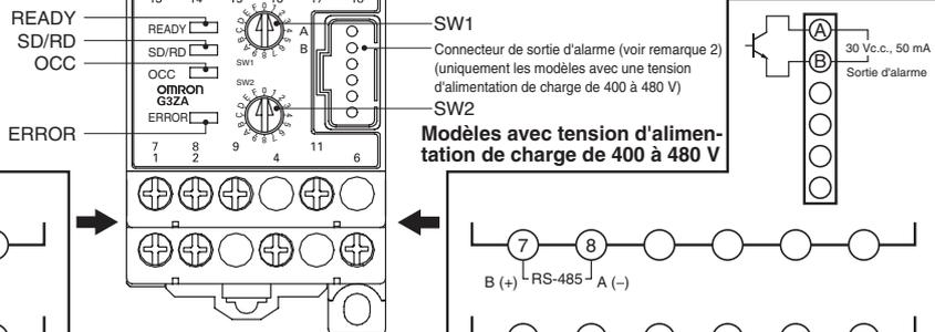
Remarque : connecter l'alimentation (100 à 240 Vc.a.) du G3ZA entre les bornes 1 et 2 et l'alimentation de charge des relais statiques entre les bornes 4 et 6.
