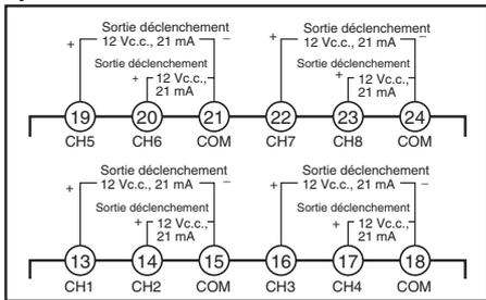
**Modèles avec 4 canaux (points de contrôle), Entrées transformateur et détection de dysfonctionnement de l'élément chauffant**
