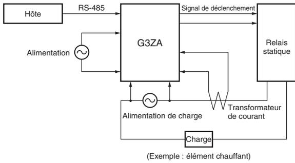
**Remarque :** Connecter une alimentation avec la même phase que les relais sur les bornes d'alimentation de charge du G3ZA.
