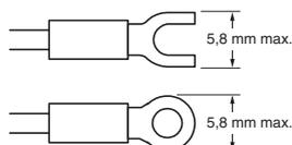
Utilisez des câbles avec une résistance minimale de 70°C.
