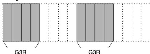
Lorsque des relais statiques G3R sont montés dans un emplacement sur deux, il est possible de commuter des charges de 2A.
