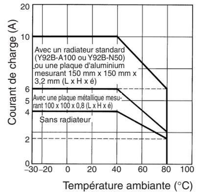
**Remarque :** La température ambiante de fonctionnement du Y92B-P250NF est comprise entre -30 to 70°C. Vérifiez que la température de fonctionnement est située dans cette plage.
