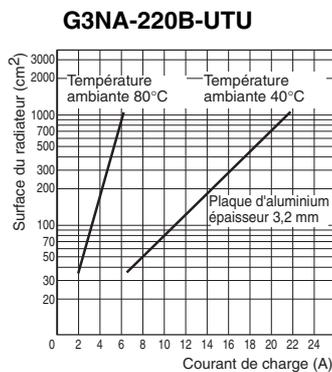
**Remarque :** La surface du radiateur fait référence à la surface totale des faces du radiateur qui dissipe la chaleur. Par exemple, si un courant de 18 A doit traverser un relais statique à 40°C, le graphique indique que la surface du radiateur doit être d'environ 450 cm<sup>2</sup>. Donc, si le radiateur est carré, un des côtés du radiateur doit avoir une longueur de 15 cm ( $\sqrt{450 \text{ (cm}^2\text{)}/2}$ ) ou plus.
