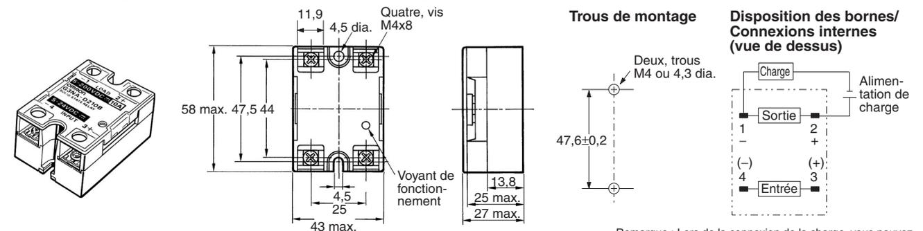
Remarque : Lors de la connexion de la charge, vous pouvez raccorder soit le côté positif, soit le côté négatif des bornes de la charge.
