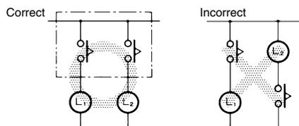
Lorsque vous concevez un circuit à auto-maintien ou à auto-réinitialisation en associant le H3YN à un relais auxiliaire, par exemple un relais MY, utilisez le circuit de sécurité qui suit.
