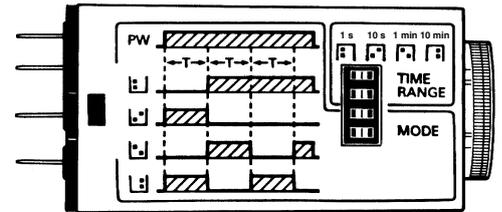
**Note** : les deux broches d'interrupteur DIP du haut sont utilisées pour sélectionner les plages de temps.
