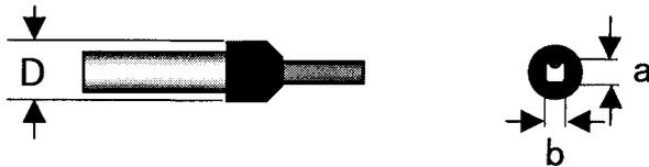
**Note : 1.** Si le diamètre total du câble est inférieur à 1,8 mm, veillez à ne pas insérer le câble au-delà du conducteur. Reportez-vous aux schémas suivants.
