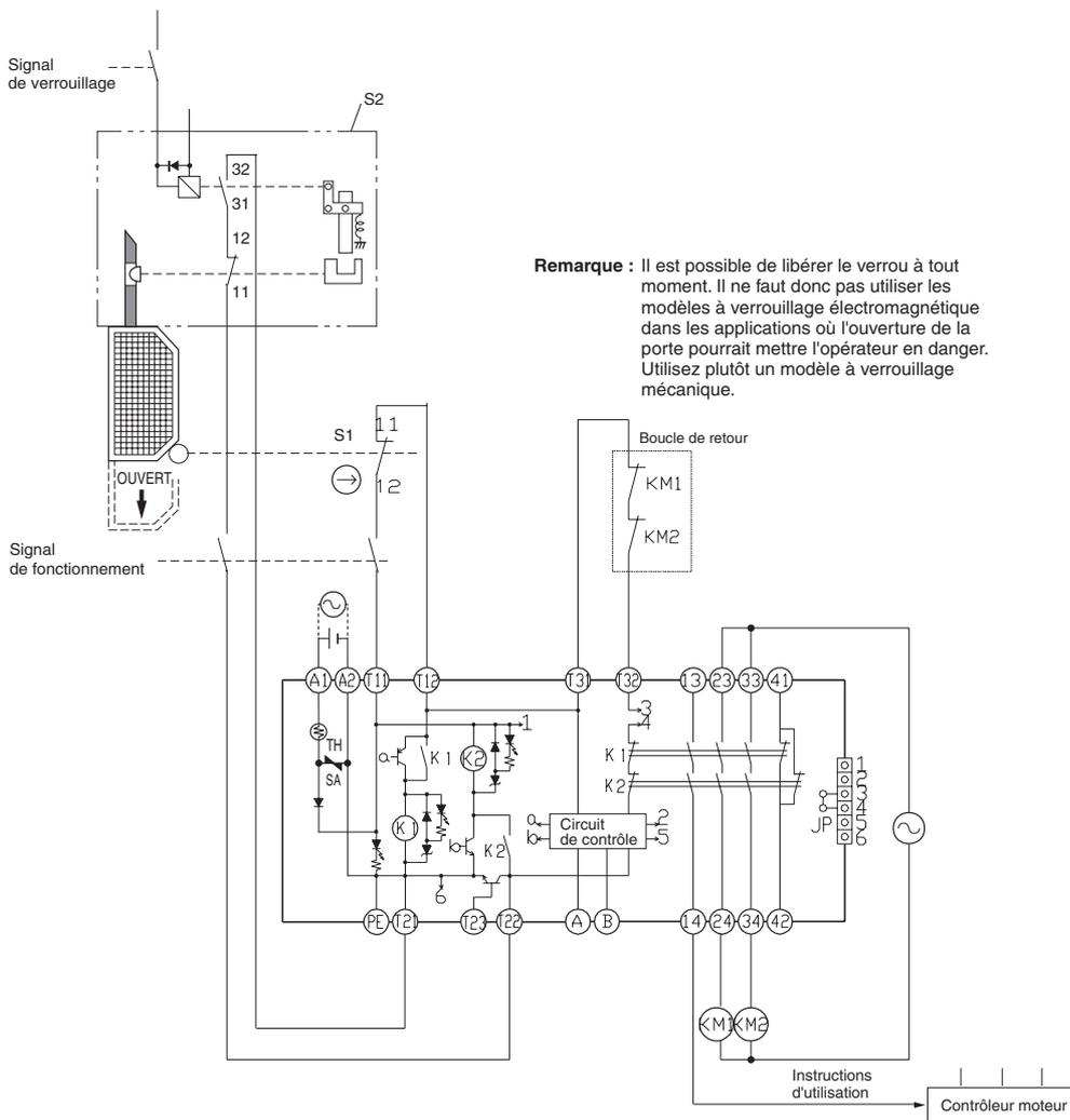
**Remarque :** Il est possible de libérer le verrou à tout moment. Il ne faut donc pas utiliser les modèles à verrouillage électromagnétique dans les applications où l'ouverture de la porte pourrait mettre l'opérateur en danger. Utilisez plutôt un modèle à verrouillage mécanique.
