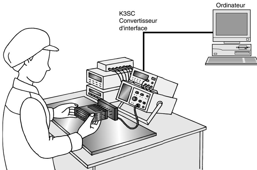
**Contrôle par ordinateur de la température d'une installation**
