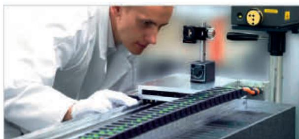
Mesure de précision avec interféromètre laser permettant à l'assurance qualité de créer les données de mappage d'étape.
