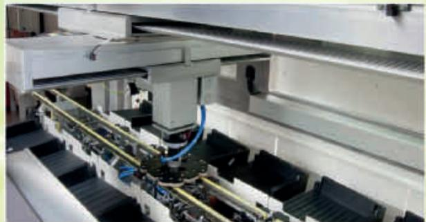
Système d'axe de moteur linéaire pour la manipulation rapide des galettes PV
