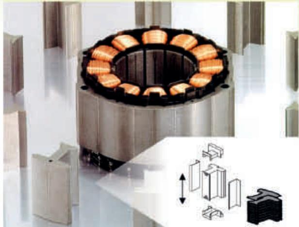
Les servomoteurs utilisent des noyaux entaillés pour augmenter la densité d'enroulement, produisant ainsi le même flux magnétique dans un moindre volume. Cependant, Omron utilise en outre la technologie PACK & CLAMP, augmentant la densité du noyau du servomoteur et réduisant de 40 % les pertes de fer. Les paquets de tôles stator sont emballés, puis simplement bridés.
