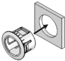
Insérez le support de fixation dans l'orifice de montage par l'avant
