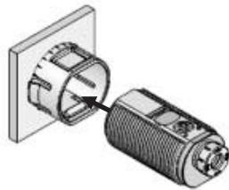
Insérez le capteur dans le support de fixation par l'arrière
