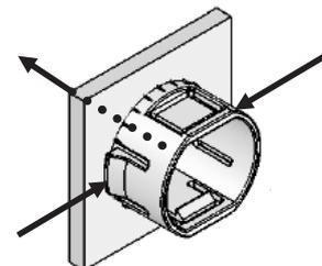
Appuyez sur les deux languettes de fixation et poussez le support de fixation vers l'avant.
