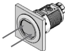
Appliquez une légère pression sur les zones indiquées de la lentille de capteur (par exemple avec les deux pouces)
