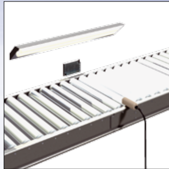
Synchronisation par impulsions pour une protection élevée par rapport à la lumière ambiante.
