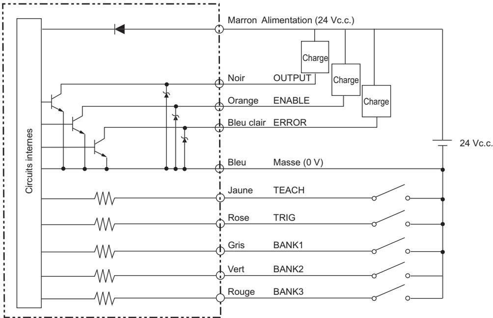
Modèles à sortie PNP (ZFV-A15 / A25)
