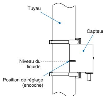
2. Une fois le détecteur installé, régler la sensibilité de détection à l'aide de la molette de sensibilité (à 12 étapes) de la façon précisée ci-dessous.
