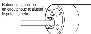
La distance de détection augmente en tournant le potentiomètre dans le sens des aiguilles d'une montre et diminue en tournant dans le sens inverse. Le potentiomètre peut faire  $15 \pm 3$  tours réels, puis des tours de glissement car il n'a pas de butée. Les tours de glissement ne risquent pas d'endommager le potentiomètre.
