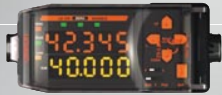
Affichage numérique hautement lisible des résultats des mesures ou d'autres paramètres de réglage
