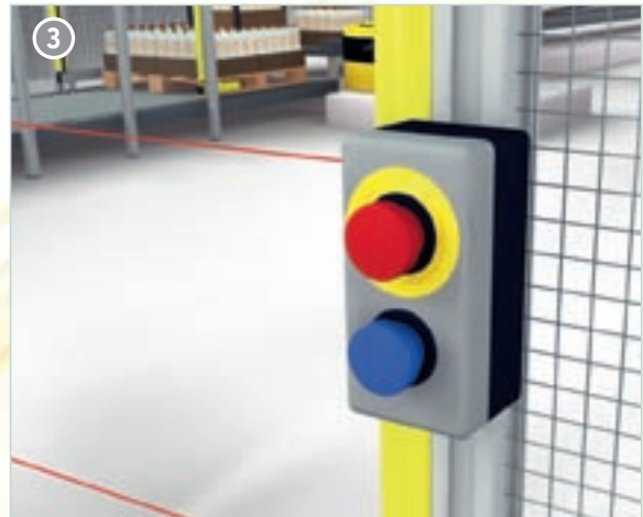
3 Bouton-poussoir RAZ pour confirmation et mise en marche
