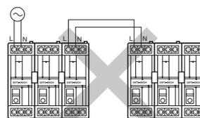
Lorsque l'on interconnecte des modules de base, il est nécessaire de câbler la borne de masse d'un seul des modules, pas de tous les modules.
