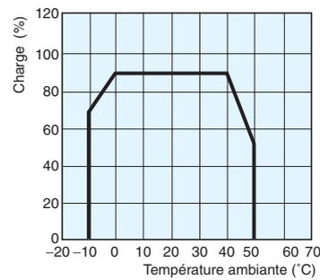
**Remarque :** S'il y a un problème de délestage, utilisez un refroidissement par convection forcée. La température ambiante est spécifiée pour un point situé 50 mm sous l'alimentation.
