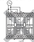
Ne croisez pas les connexions entre modules ou entre un module et un autre dispositif. En cas de dépassement du courant nominal, les connecteurs peuvent être endommagés.
