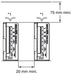
La figure ci-dessus illustre un modèle avec le bornier orienté vers le haut.
