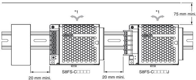
Pour monter le système d'alimentation sur un rail DIN, accrochez la partie (A) du système d'alimentation sur le rail DIN et appuyez l'alimentation en poussant dans la direction (B) jusqu'à entendre un dé clic. Assurez-vous que la tige de verrouillage du support de montage s'emboîte avec le rail DIN.
