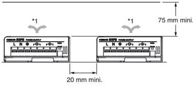
La figure ci-dessus illustre un modèle avec le bornier orienté vers le haut.
