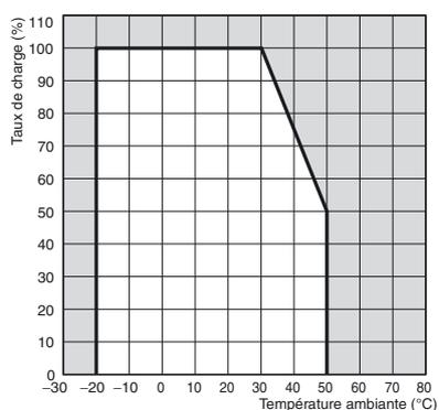
**Remarque :** Il arrive que les composants internes se détériorent ou soient endommagés. Utilisez uniquement la méthode de montage standard. N'utilisez pas l'alimentation dans la zone hors des limites de la courbe de derating.
