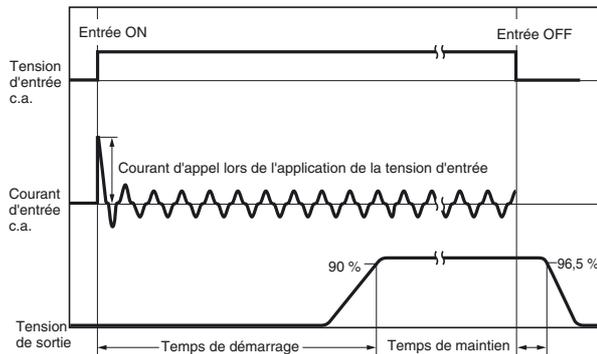
**Remarque :** En fonctionnement parallèle ou redondant, le courant d'entrée qui circule est doublé. Vérifiez donc les caractéristiques de fusion des fusibles et les caractéristiques de fonctionnement des disjoncteurs pour être certain que les fusibles ne fondront pas et que les disjoncteurs ne seront pas activés sous l'effet du courant d'appel.
