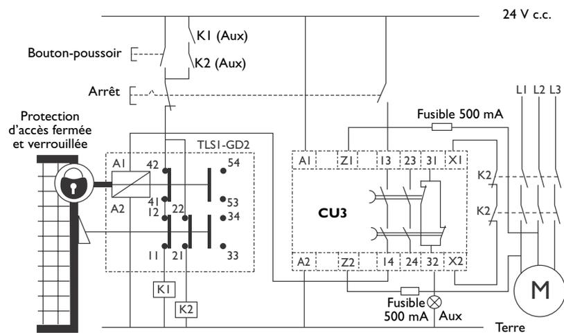
Interverrouillage de protecteur, détection de force CEM, réarmement automatique, sortie surveillée.
