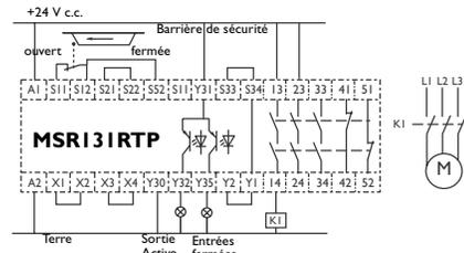
*Barrière de sécurité simple voie, réarmement automatique, sans surveillance de la sortie*
