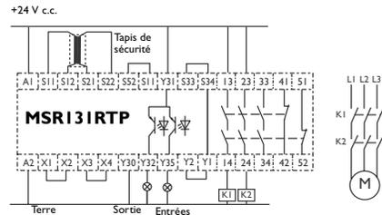
*Tapis de sécurité, réarmement automatique, sans surveillance de la sortie*
