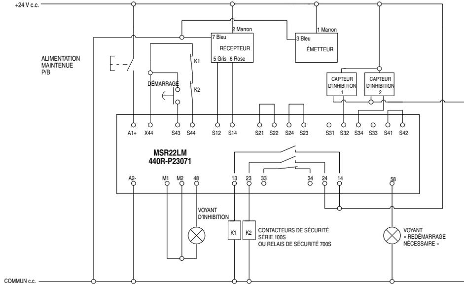
Barrière immatérielle GuardShield connectée au MSR22LM avec quatre détecteurs d'inhibition
