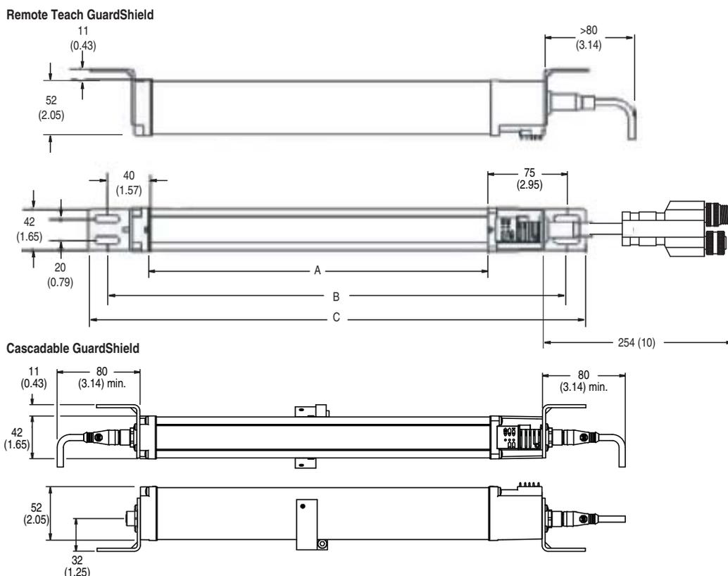
**Remarque :** le support de fixation du milieu doit être utilisé dans les applications soumises aux vibrations pour les barrières immatérielles GuardShield dont la hauteur de protection est de 1120 mm ou plus.
