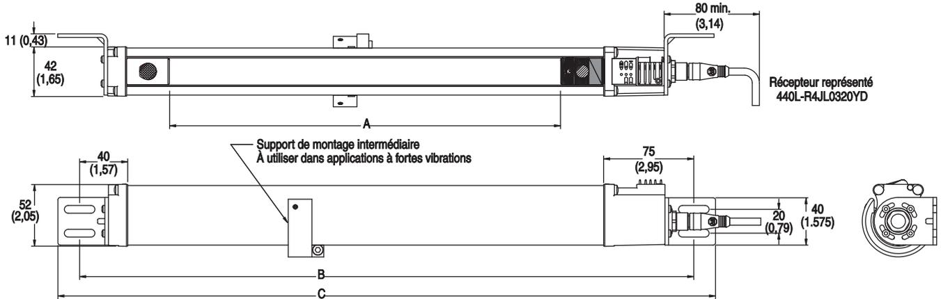
Emetteur GuardShield standard avec alignement laser intégré
