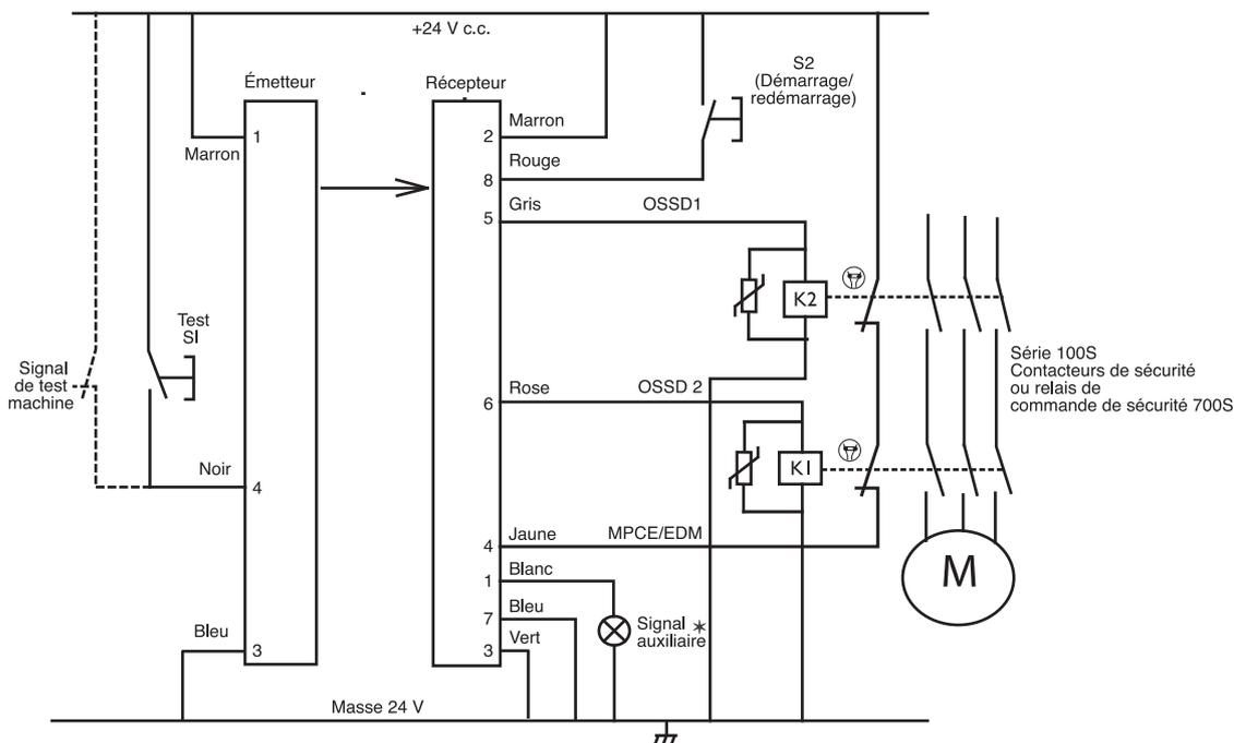
\* La sortie auxiliaire n'est pas une sortie de sécurité. Peut être raccordée à un voyant, moteur ou l'état vers un automate.
