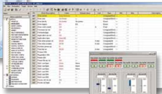
Tous les drives de la série SIEDrive et les dispositifs d'Automation du Groupe GEF-RAN (PLC, HMI, Instruments, etc.) peuvent être programmés par PC à l'aide du configurateur **GF-eXpress**. L'outil pour PC permet la **programmation et le contrôle complet du produit**, grâce à une structure de logiciel puissante, intuitive et facile à mettre en oeuvre pour n'importe quel opérateur :
