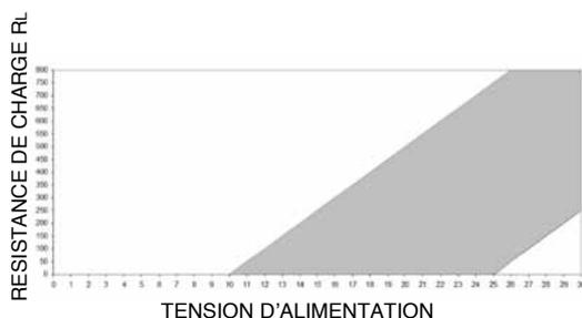
Ce diagramme représente le rapport optimal entre la charge et l'alimentation pour transmetteurs avec sortie 4...20mA. Pour le fonctionnement correct, utiliser une combinaison de résistance de charge et tension d'alimentation en mesure de rester dans la zone en pointillé
