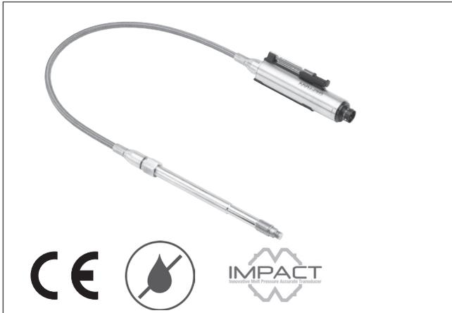
La dénomination IMPACT – une exclusivité Gefran – identifie une gamme de capteurs de pression pour hautes températures, qui utilisent le principe piézorésistif. La principale caractéristique des capteurs “IMPACT” réside dans l’absence de tout fluide de transmission.
