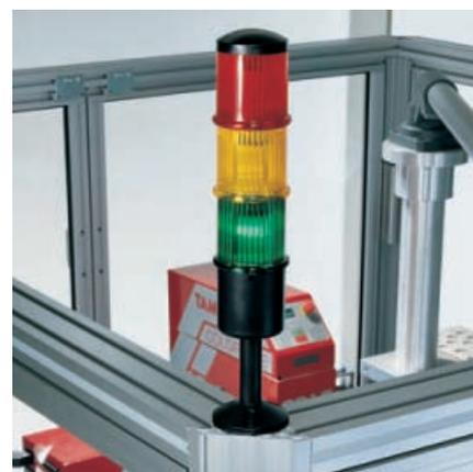
Les balises lumineuses SL signalent de façon claire et univoque l'état de fonctionnement des machines.
