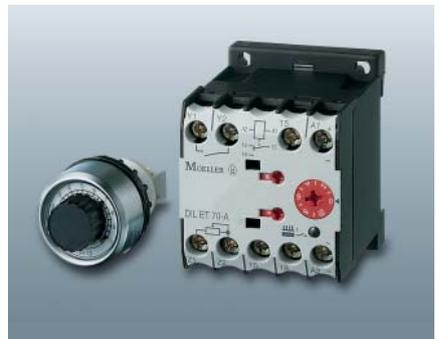
Avec le DIL ET 70, la temporisation peut également être réglée à partir de la porte de l'armoire en cas de raccordement d'un potentiomètre aux bornes Z1/Z2. Le potentiomètre possède un degré de protection IP 54.
