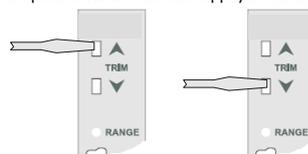
4.0 Une fois le réglage effectué attendre 30 s. sans appuyer aucun bouton et le convertisseur reviendra au mode de fonctionnement normal en conservant les nouveaux réglages.
