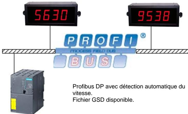
Profibus DP avec détection automatique du vitesse.
