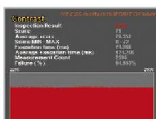
L'étape finale consiste en une simple vérification du bon fonctionnement du programme d'inspection ainsi qu'en son enregistrement dans la mémoire du capteur. Cette opération réalisée, la configuration est terminée et le capteur peut fonctionner en complète autonomie.
