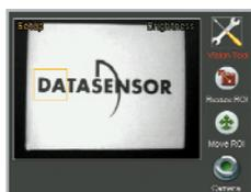
La première étape permet de se connecter au capteur et de configurer les paramètres associés à la qualité de l'image. Une fois que l'on a obtenu les résultats souhaités, il faut sélectionner le type de contrôle que l'on souhaite utiliser.
