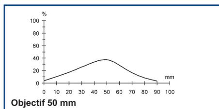
Les données de distance opérationnelle indiquent la distance de détection avec gain 2.
