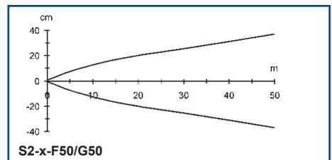
Les diagrammes de détection indiquent la distance opérationnelle typique avec gain 1.
