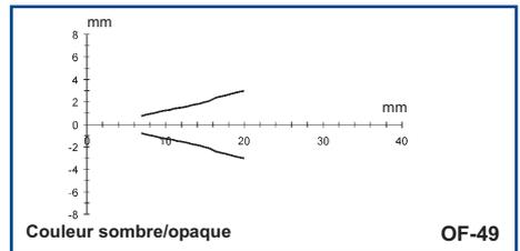
Les données de distance opérationnelle indiquent la distance de détection avec gain 2.
