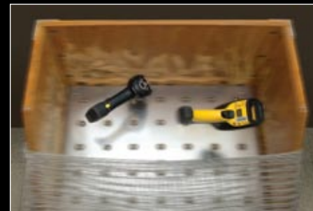
Test de vibrations : 10 heures de chocs et vibrations sur une surface métallique
