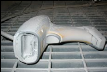
Test de la pénétration des poussières et particules : équivalent à 5 - 7 ans en environnement industriel
