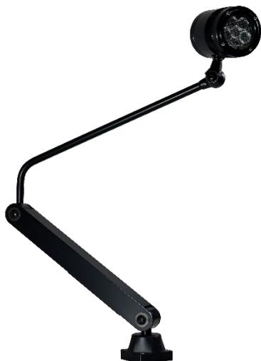
Lampe à LED avec bras articulé en métal. Idéale pour les postes de travail et les machines-outils manuelles comme les fraiseuses, les tours et les perceuses. L'extraordinaire flexibilité du bras permet d'orienter la lampe avec précision. Lentille avec angle d'émission de 40° Variateur avec commande tactile.
