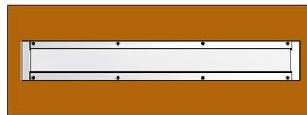
Utiliser des vis M5 pour installer et fixer la lampe.
