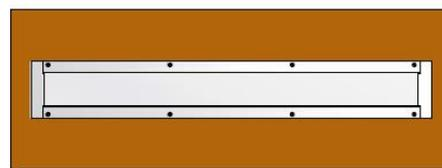
Utiliser des vis M5 pour installer et fixer la lampe.
