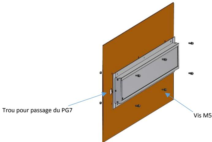
Pour les dimensions des trous de fixation et pour la position du PG7, voir Dessin 1.0.
