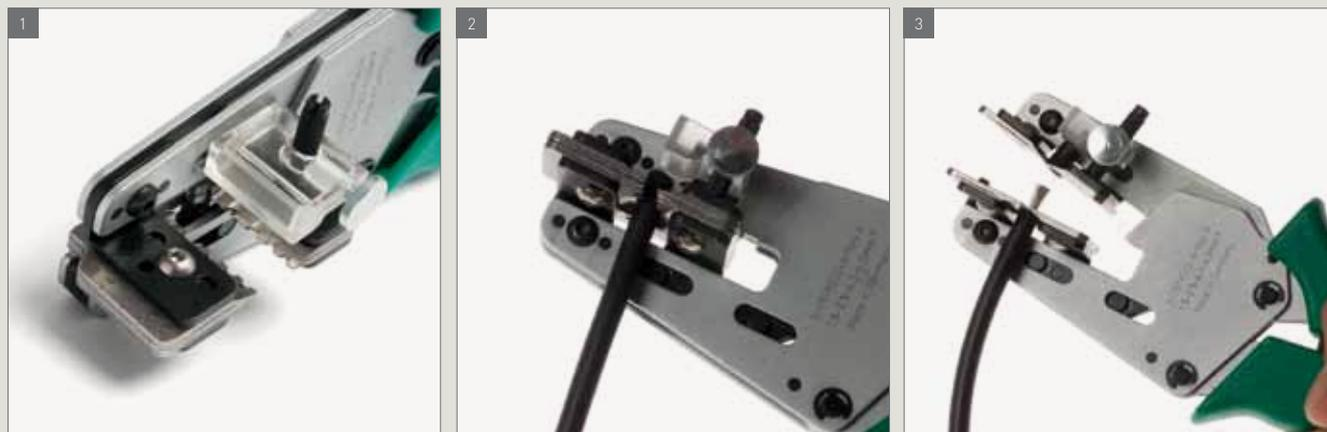
1. Le dénudeur de fils fonctionne comme une guillotine et les différentes gorges, adaptées aux différentes sections des câbles, garantissent un dénudage rapide et sûr.
