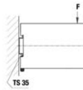
Pied encliquetable pour la fixation des rails (monté en usine) ; charge admissible, F = charge permanente max. 40 N
