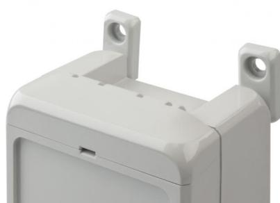
Les fixations murales sont utilisables pour toutes les tailles Bocube. Elles sont vissées dans les perçages préparés au dos de la partie inférieure du boîtier.
