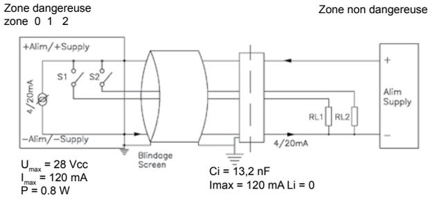
En zone 0, l'association du pressostat et de la barrière de sécurité doit faire l'objet d'un calcul de boucle vérifié par un organisme notifié. Pour l'application en zone Ex, vous devez respecter les conditions mentionnées dans le certificat d'examen de type (LCIE 03 ATEX 6300 X). Vous trouverez les certificats et manuels sous <http://www.baumer.com>
