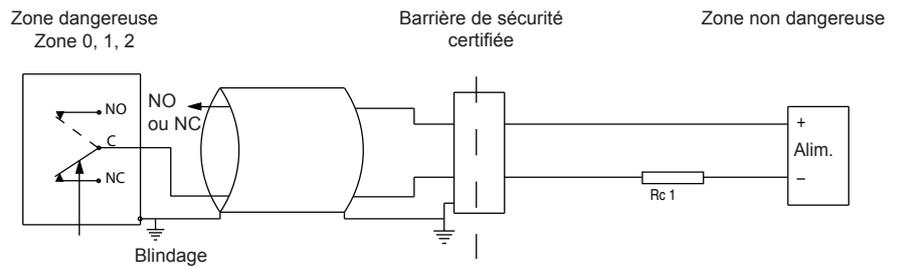
Pour max. température ambiante en fonction de la température des classes T5 et T6 se référer aux données techniques en page 1. L'installation doit être faite dans un circuit de sécurité intrinsèque dont les paramètres de sécurité électrique certifiés ne dépassent pas les valeurs  $U_{max}$ ,  $I_{max}$  et  $P_{max}$  donnés dans les caractéristiques électriques de la page 1.
