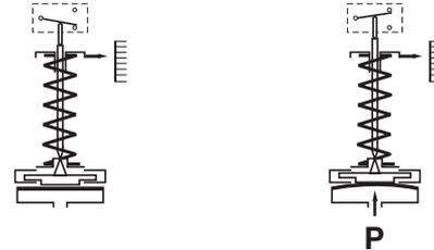
Le point de consigne et la mise à zéro doivent être compris entre 10% et 90% de l'échelle.
