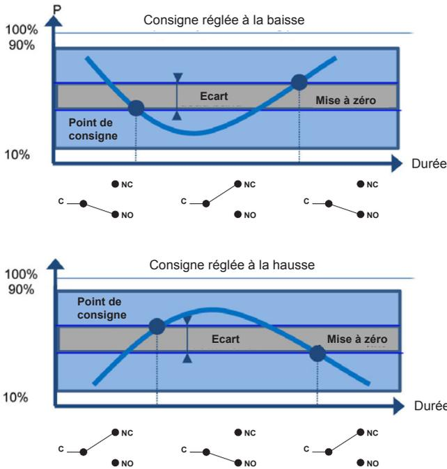
Un élément déformable, membrane, actionne un microrupteur par l'intermédiaire d'un piston. Le réglage de la consigne est obtenu par un ressort comprimable monté en opposition.
