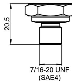
7/16-20 UNF avec joint torique (SAE 4) (BCID: U02)
