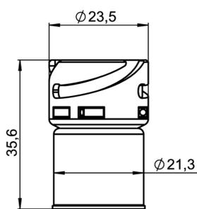
Boîtier avec connecteur Connecteur Bayonet DIN 72585, 4 pôles
