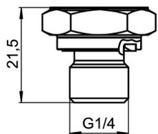
G 1/4 A DIN 3852-E avec canal de pression Ø 0,6 mm (BCID: G50)
