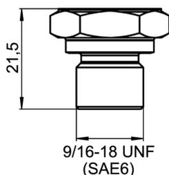
9/16-18 UNF avec joint torique (SAE 6) (BCID: U04)
