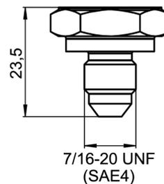
7/16-20 UNF avec cône (SAE 4) (BCID: U01)
