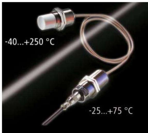
Les détecteurs de proximité capacitifs permettent de détecter sans contact le niveau des liquides ou des matières, sous forme de granulés ou pulvérisées, dans des conduites ou des réservoirs. La détection peut se faire au travers de parois en matière plastique, verre, etc...
