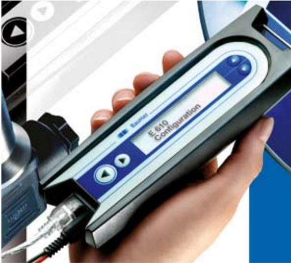
Le Flexprogrammer 9701 est un convertisseur convivial pour tous les transmetteurs programmables (4...20 mA). Outre une configuration directe à partir d'un PC, il permet également la configuration à distance et peut donc être utilisé de façon flexible et mobile dans tous les environnements.
