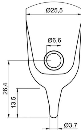
Embout du capteur avec élément de capteur
