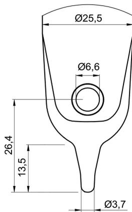
Embout du capteur avec élément de capteur
